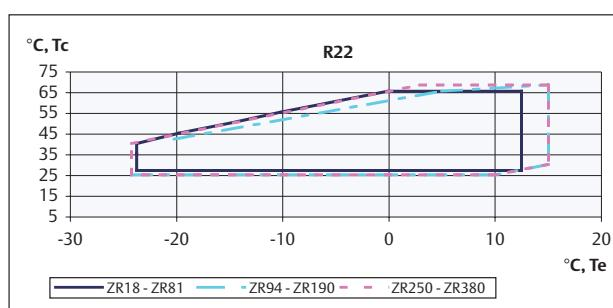
Te = Evaporating temperature / Température d'évaporation / Verdampfungstemperatur
